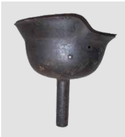
Deutscher Stahlhelm (Modell 1935 ?) als Lötgefäß. St. Leonhard in Passeier, Fotoarchiv Andreas Rauchegger
