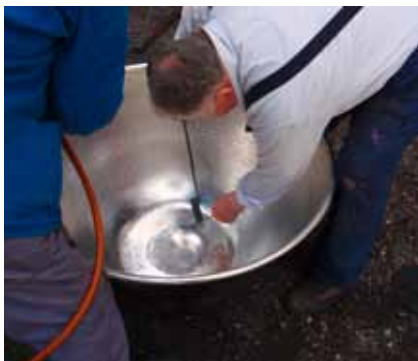
Donato Zandonella aus Dosoledo, Jg. 1943, bei der Feuerverzinnung einer Teigmixmaschine im Jahr 2005.
