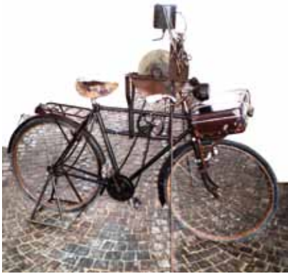
Scherenschleiferstand und -rad, wurde im Südtiroler Unterland in den 1950er Jahren verwendet. Museum Zeitreise Mensch, Kurtatsch, Fotoarchiv Andreas Rauchegger
